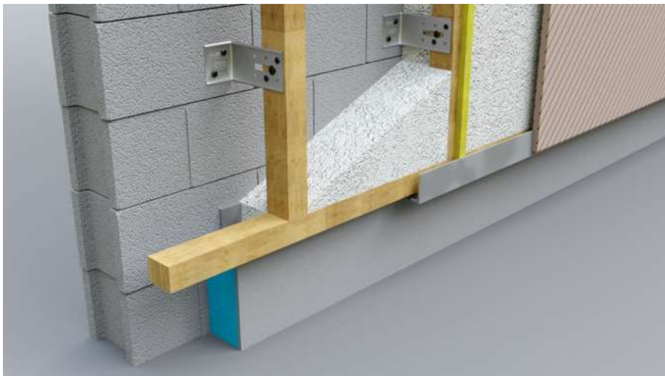
Figure 14 : détail pied de mur arrêt isolation extérieure / raccord continuité thermique garde au sol de 15 cm
