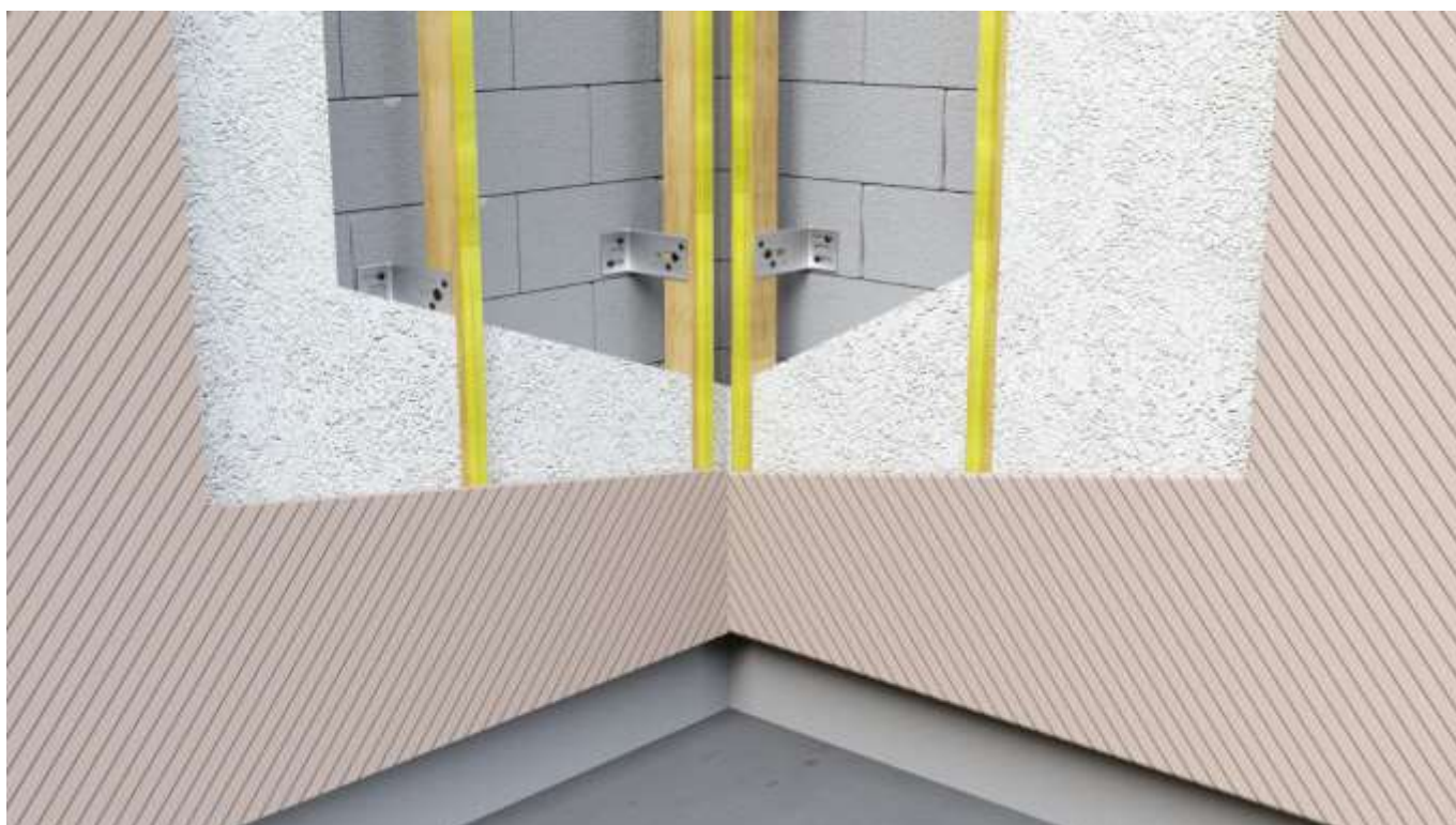
Figure 6 : détail continuité thermique angle rentrant -
