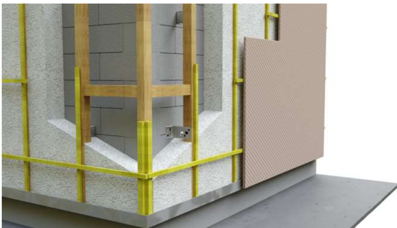
Figure 9 : détail continuité thermique angle sortant
