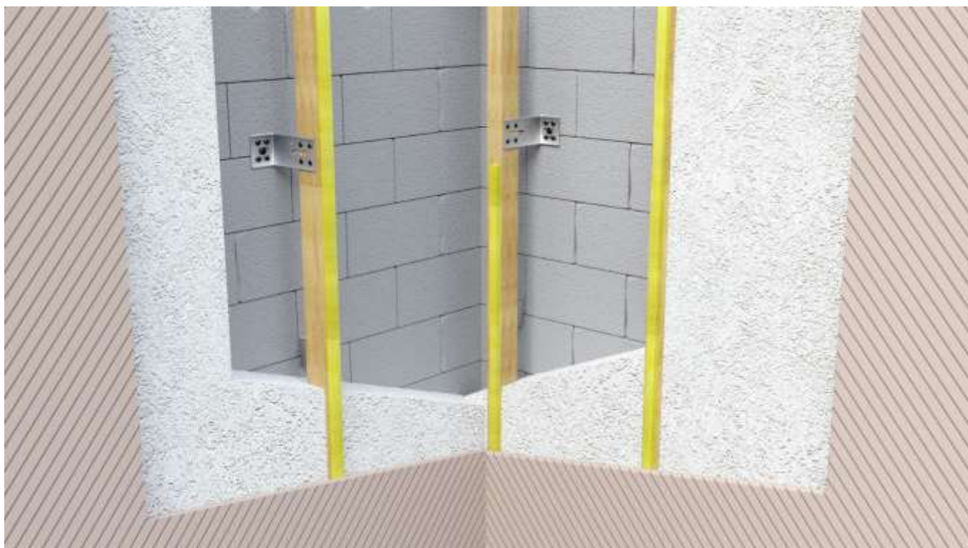
Figure 8 : détail continuité thermique angle rentrant paroi courante
