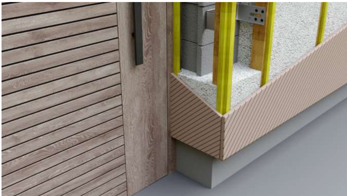
Figure 5 : détail raccord de l'isolant avec porte accès
