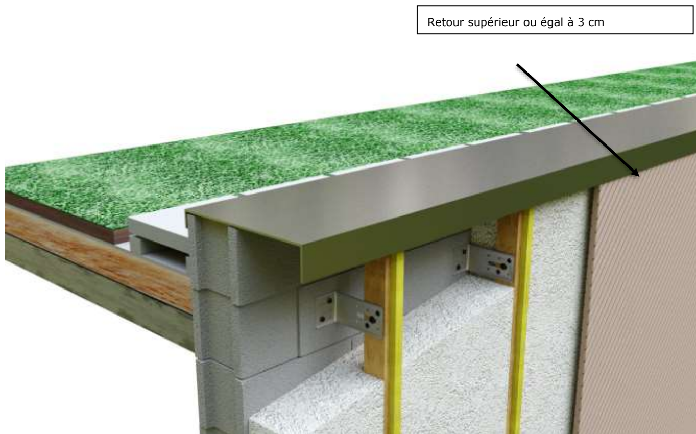
Figure 10 : détail raccord acrotère cas de la toiture terrasse le retour de la couverture recouvre le bardage sur plus de 3 cm
